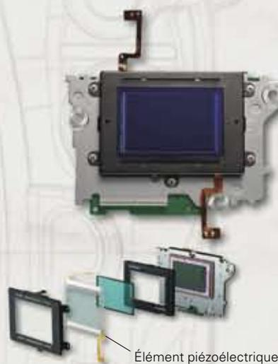
Fonction de nettoyage du capteur d'image D700
